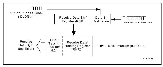
FIGURE 10. RECEIVER OPERATION IN FIFO AND AUTO RTS FLOW CONTROL MODE
